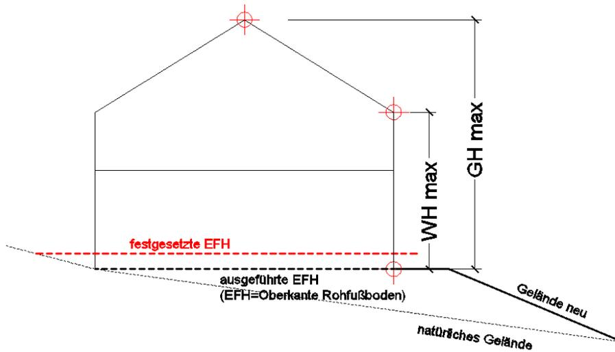
Abbildung 1: Erläuterungsskizze, zweiseitig geneigtes Dach (Satteldach und Walmdach)
